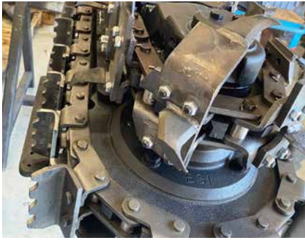
Kernstück der Harvestore-Technik: Die Untenentnahmefräse
