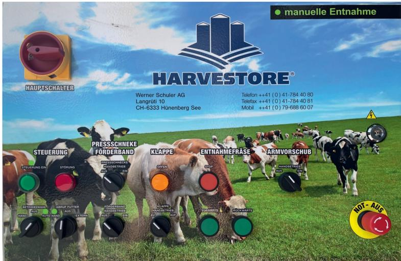
L'opérateur commande l'avance du bras grâce au système innovant Arm Advance Sentry™ sur le boîtier de commande. De plus, un variateur de fréquence est intégré pour l'ensilage de gazon et un démarrage progressif pour l'ensilage de maïs, afin d'éviter les chocs sur les chaînes.
