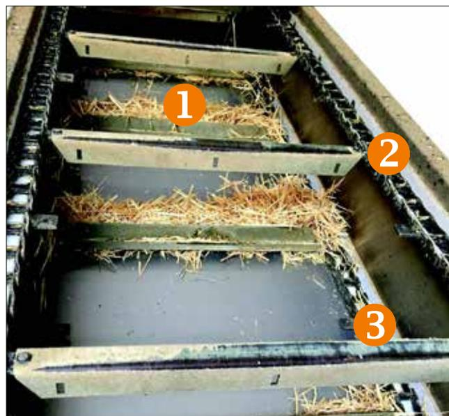
1. Lamelles de transport en acier galvanisé, en forme de U pour plus de rigidité.
