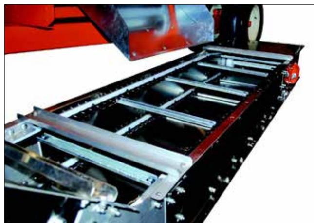
Sections de convoyeur disponibles dans les longueurs suivantes : 305 cm, 152 cm et 76 cm, largeur des sections : 61 cm
